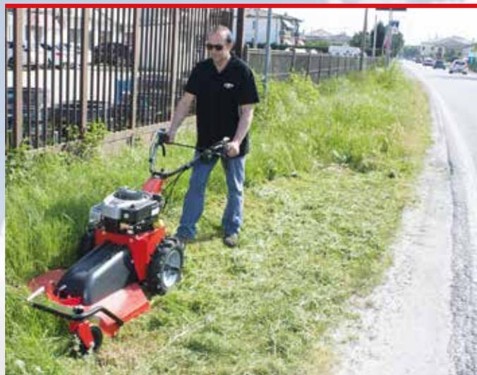
Rasaerba professionale, maneggevole, compatto, di facile uso in qualunque condizione di taglio. Dotato di cambio a tre velocità avanti e una retromarcia con sistema di frenaggio ruote, regolazione del taglio manuale e stegole di guida regolabili in altezza e lateralmente.
