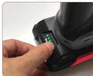
Premere il pulsante situato sul lato posteriore del potatore per visualizzare la carica della batteria
