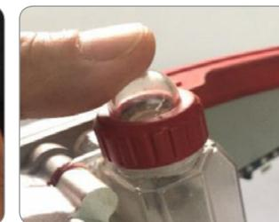
Serbatoio dell'olio per lubrificazione della catena
