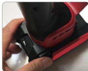
Far scivolare la batteria nell'alloggiamento finché non scatta in posizione. Per rimuovere la batteria premere i pulsanti laterali e tirare.
